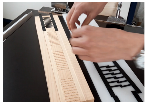
Abb. 12: Einlegen von 3D-gedruckten überlappenden Sensorbausteinen in ein gefrästes Negativ-Muster
