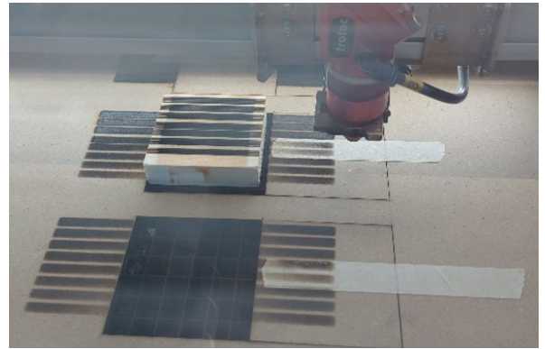
Abb. 13: Laser Graphitisierung auf Holz mit einer lignin-basierten Tinte
