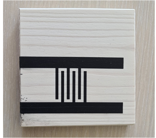
Abb. 6: Links: Grundierung auf Fichtenholz. Die Drucktinte diffundiert in die Beschichtung; Rechts: Mittels Inkjet gedruckter Feuchtesensor
