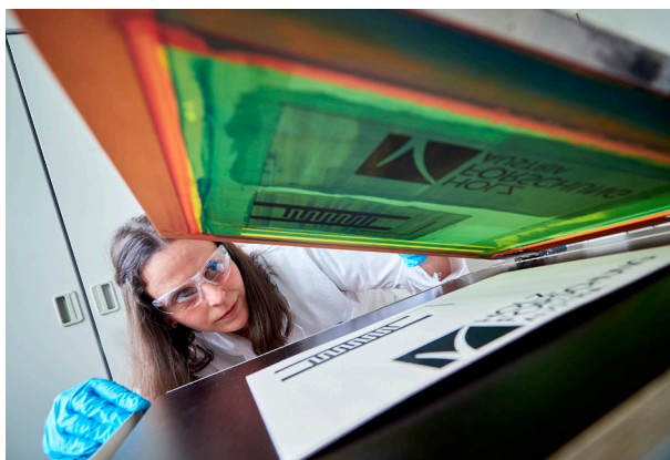
Abb. 7: Sensordruck mittels manuellem Siebdruck (©: ACR/schewig-fotodesign)
