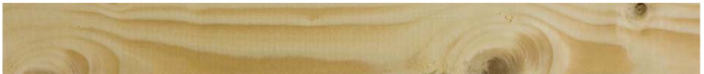
Abb. 1: Holzoberfläche mit Ästen (Fichte)
