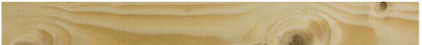
Abb. 1: Holzoberfläche mit Ästen (Fichte)
