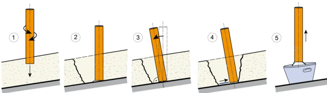
Abb. 1: Entnahme einer Schneeprobe am Dach gemäß Winter (2007) [6]
